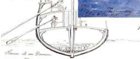
Sección vertical por la línea central. Sección de un Pampilio. Sección de un Pampilio. Sección de un Pampilio.
