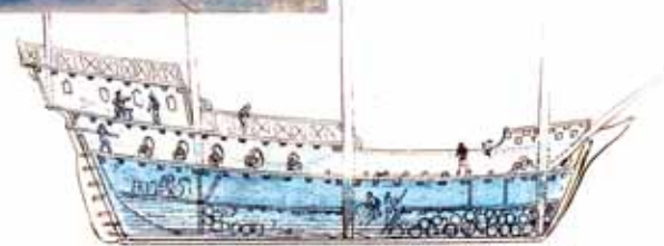
Sección longitudinal por la línea del centro de una Carabela. Medida 31 por 10 m. 10. Longitud 12 m. 10.
